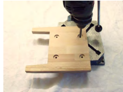
Nach dem Fresen erst die Löcher mit dem Spiral - bohrer durchbohren.
