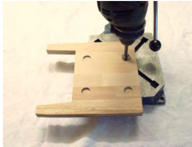
Erst mit dem Forstnerbohrer ca. 10 mm tief fräsen
